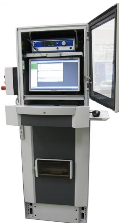
Rollscan 250 in einem PC-Schaltschrank
